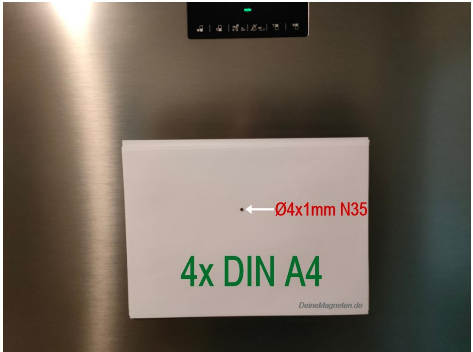
Tragkraft-Test des 4x1mm N35 Neodym Scheibenmagneten von Deinemagneten am Kühlschrank.
