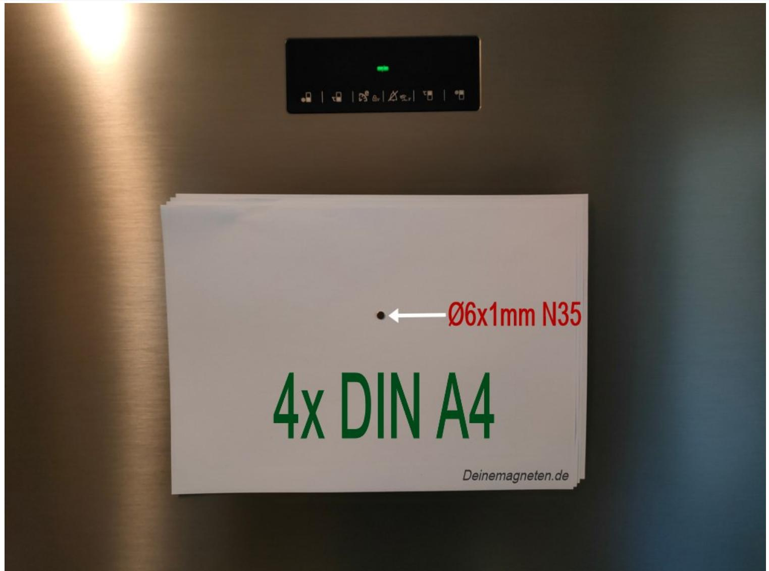
Dieser Hafttest am Kühlschrank soll zeigen, wie viele DIN A4 Blätter bzw. das Gewicht dieser der 6x1mm N35 halten kann. Foto: [deinemagneten.de](http://deinemagneten.de)
