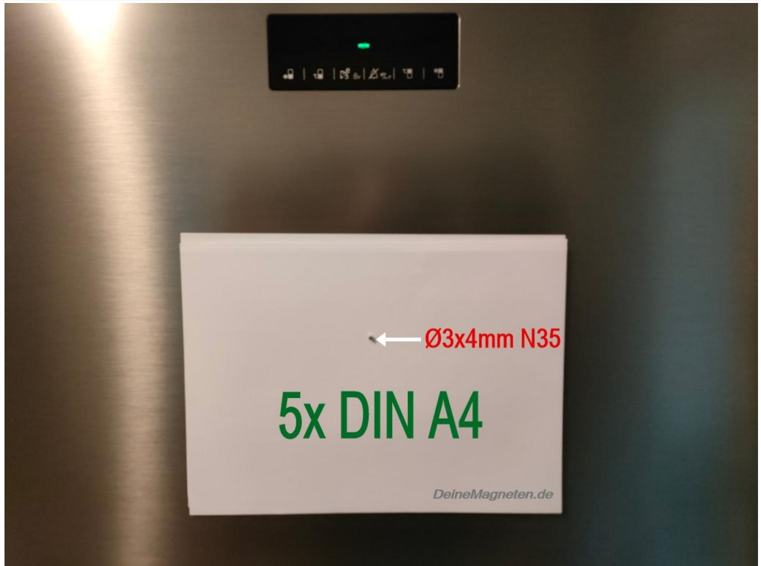
Der 3x4mm N35 Neodym Scheibenmagnet von Deinemagneten im Hafttest. Foto: [deinemagneten.de](http://deinemagneten.de)
