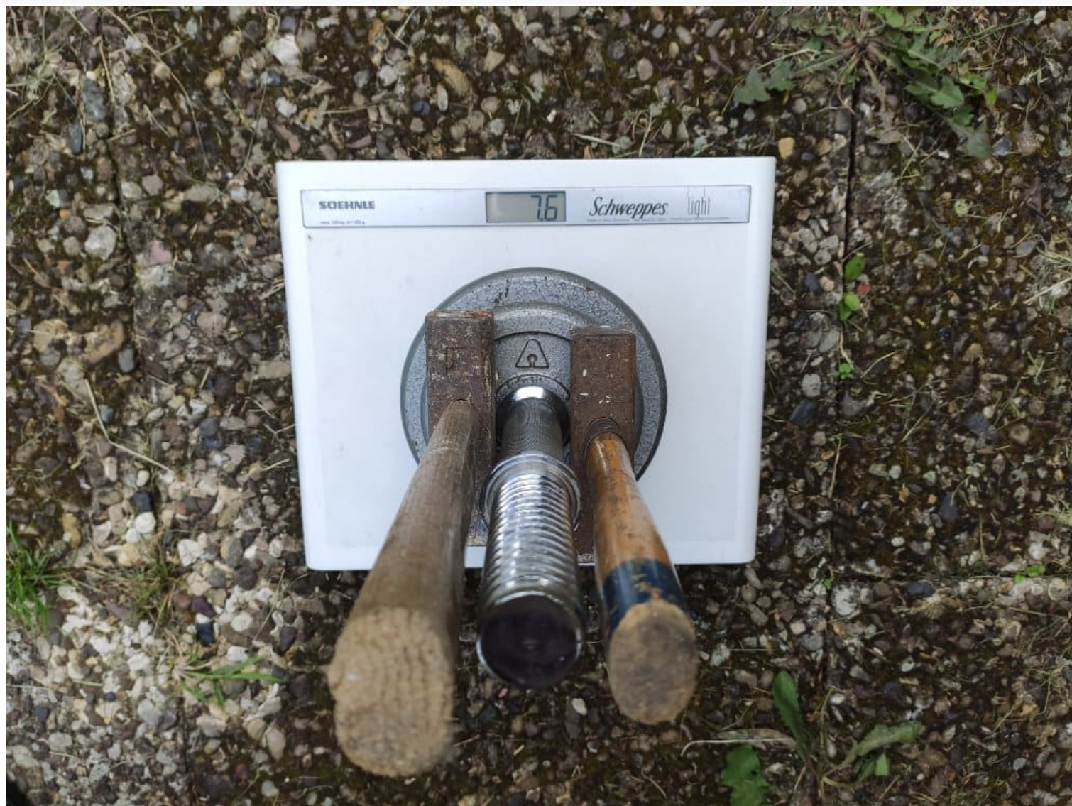
7,6 KILOGRAMM AM 40X5 N35 NEODYM MAGNETEN
