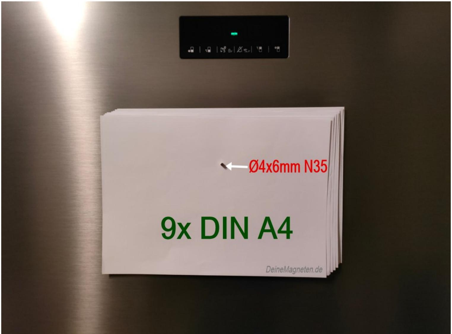
Unser 4x6mm N35 Stabmagnet konnte im Hafttest 9 DIN A4 Blätter befestigen. Foto: [deinemagneten.de](http://deinemagneten.de)
