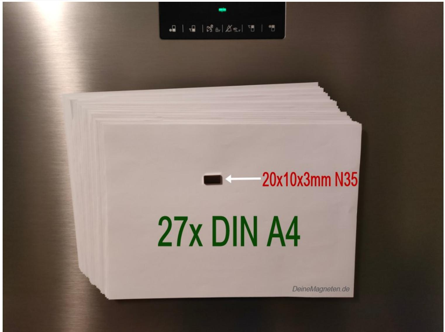
Starke Leistung: Der 20x10x3mm N35 NdFeB Quader Magnet hält 27 Stück DIN A4 Papier auf Kühlschranktür. Foto: deinemagneten.de
