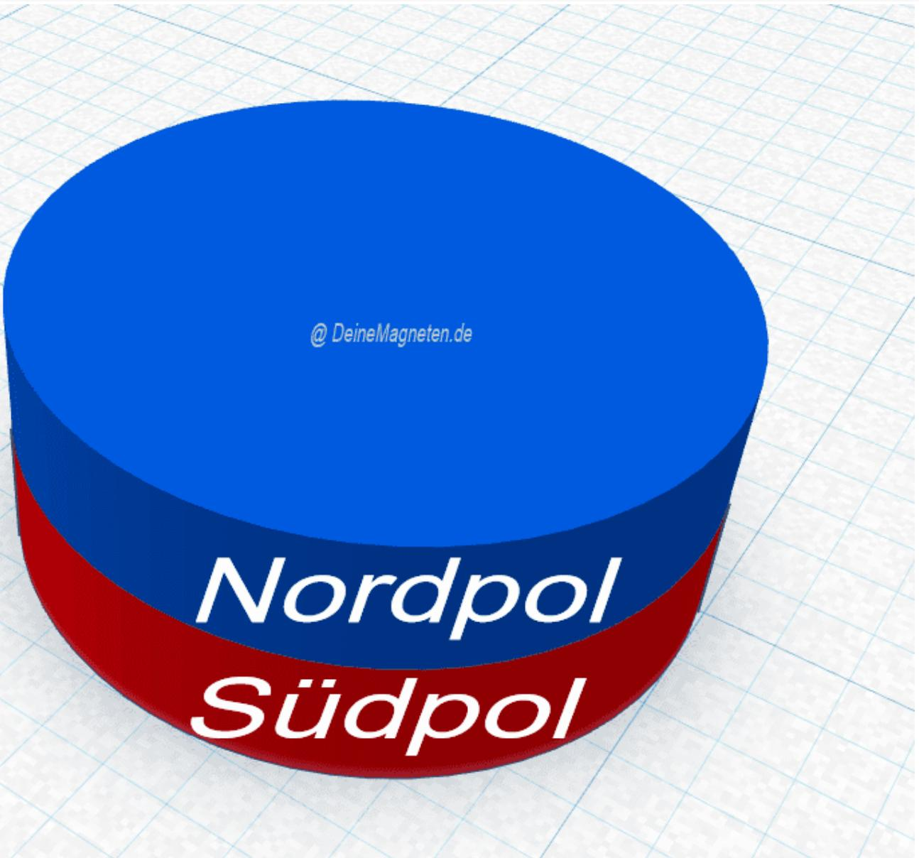
Fürs bessere Verständnis: Nord- und Südpol bei Magneten. Grafik: Deinemagneten.de
