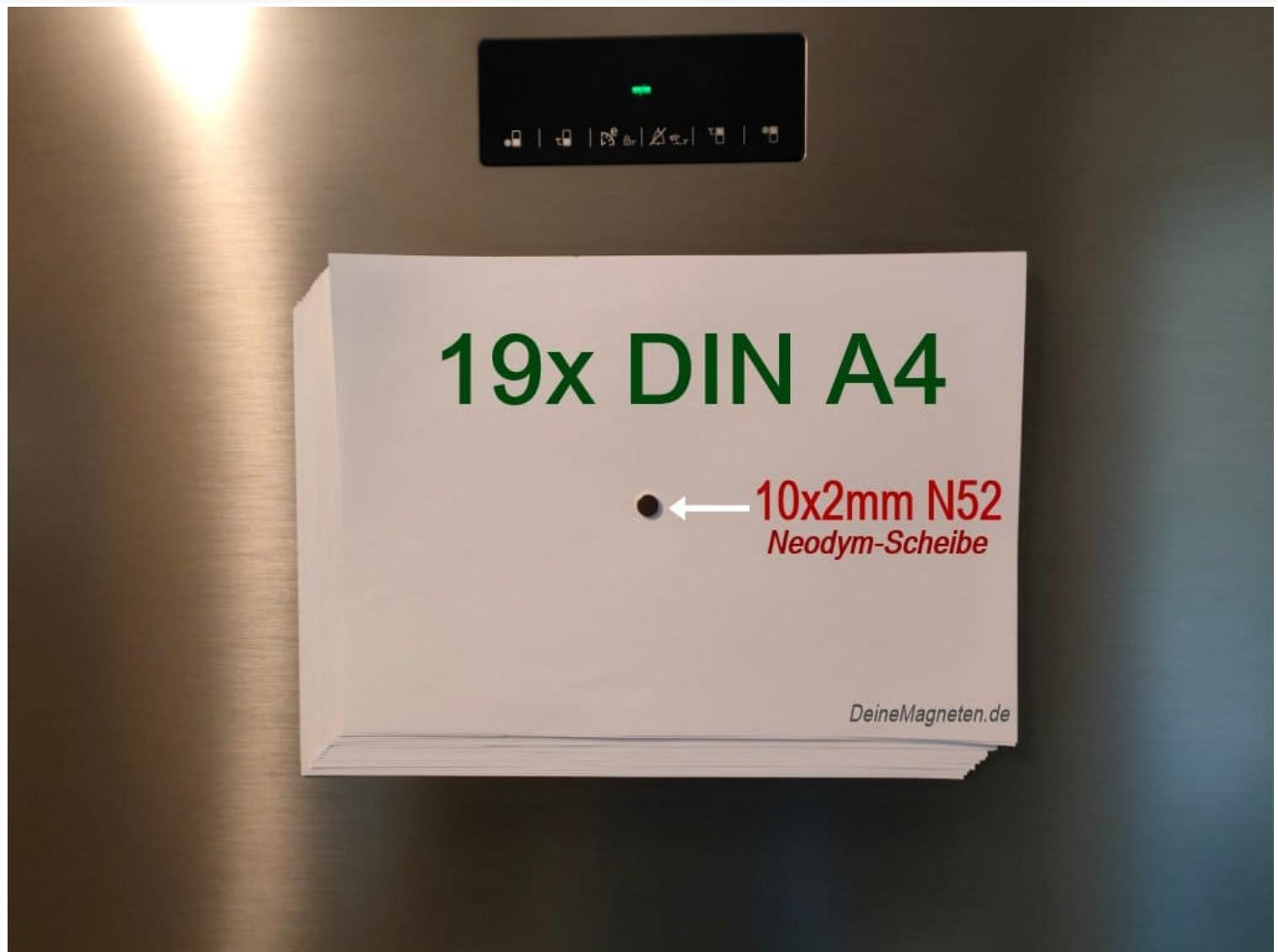
Zugkraft des 10x2 N52 an der Kühlschranktür getestet.
