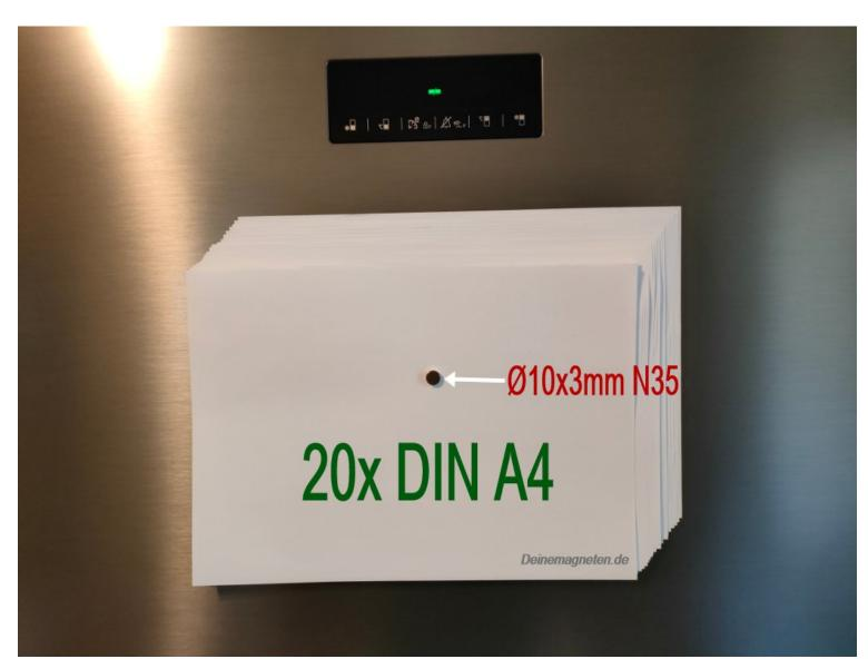
Hafttest 10x3mm N35 Neodym Rundmagnet. Foto: Deinemagneten.de
