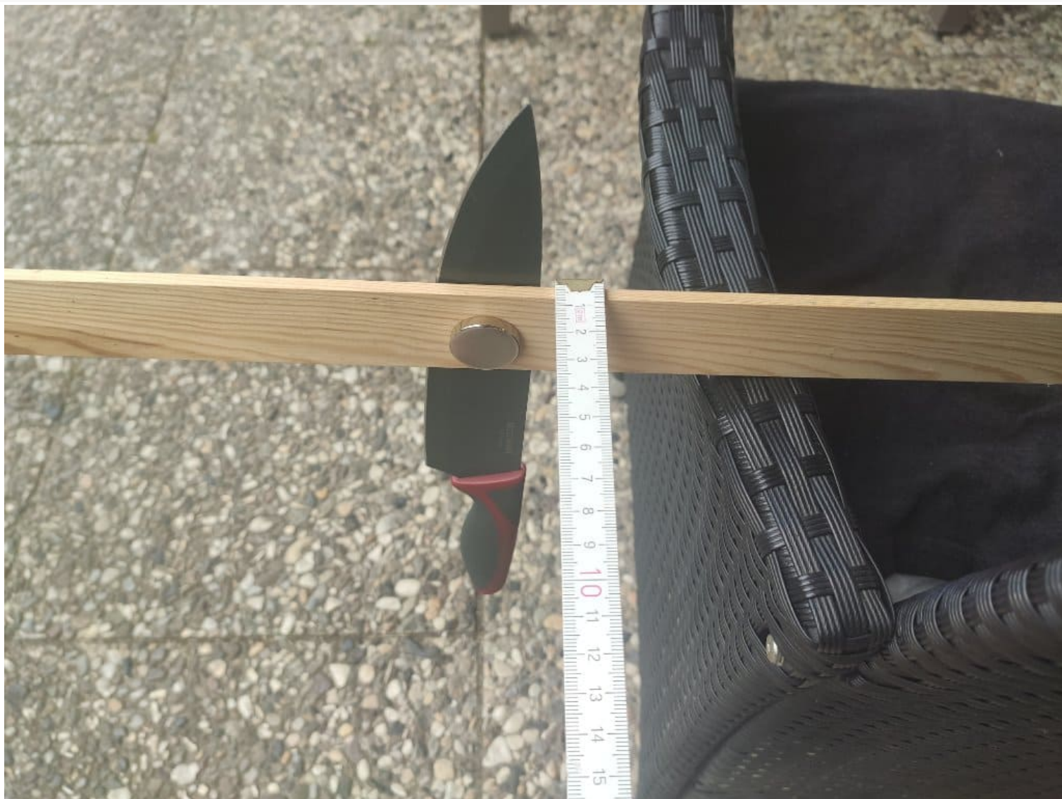
0,5 cm Holz zwischen 25x5mm N45 Scheibenmagnet und Messer. Foto: Deinemagneten
