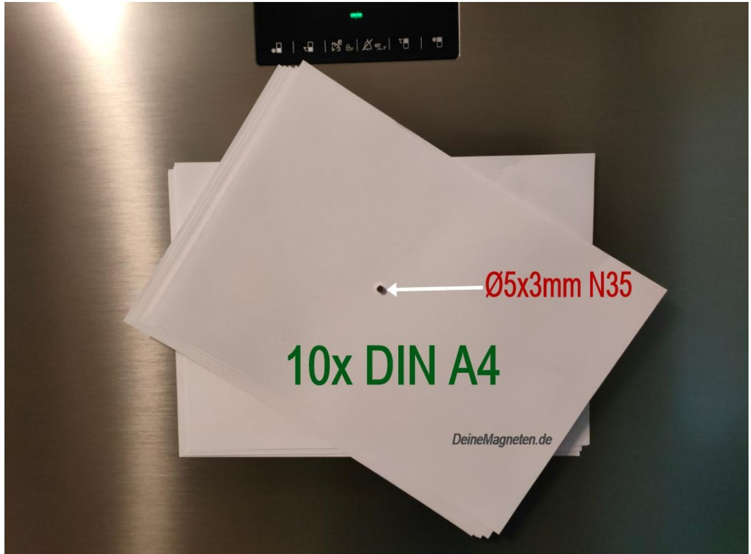
Im Hafttest am Kühlschrank konnte der 5x3mm N35 Neodym-Rundmagnet insgesamt 10 Stück DIN A4 Papier halten. Foto: deinemagneten.de
