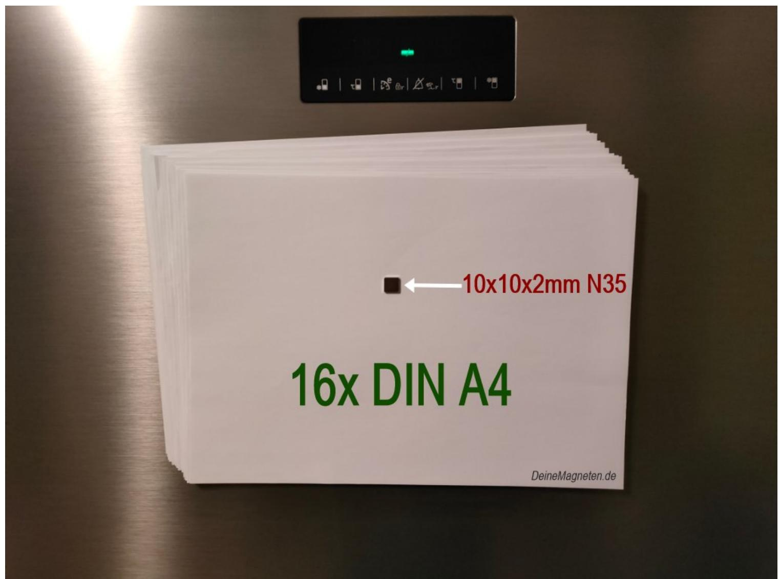
Wie stark ist ein Quader Magnet in der Größe 10x10x2mm und der Stärke N35? In diesem Test zeigen wir dies auf einer Kühlschranktür. Foto: deinemagneten.de
