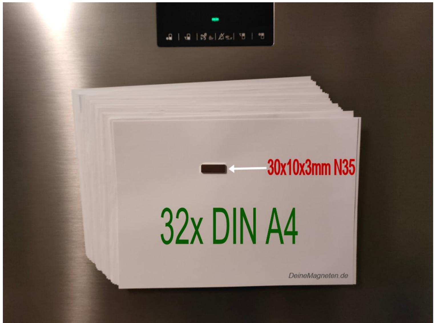
Hafttest des 30x10mm (Länge x Breite) und 3mm Dicken N35 Starknagneten am Kühlschrank. Foto: deinemagneten.de
