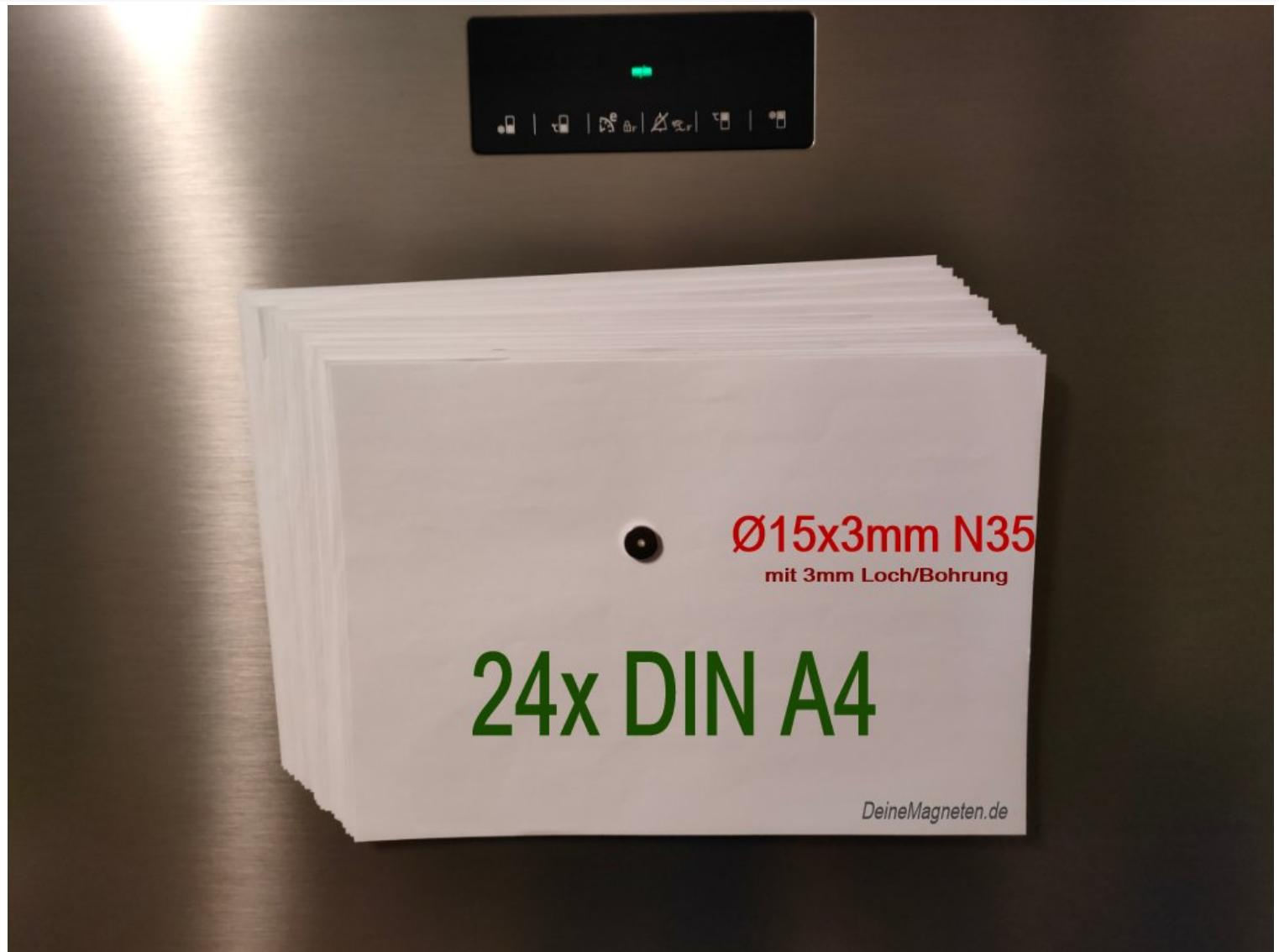
Ermittlung der Stärke des Magneten: Neodym Ringmagnet 15x3mm mit 3mm Loch an der Kühlzentraltür. Foto: deinemagneten.de
