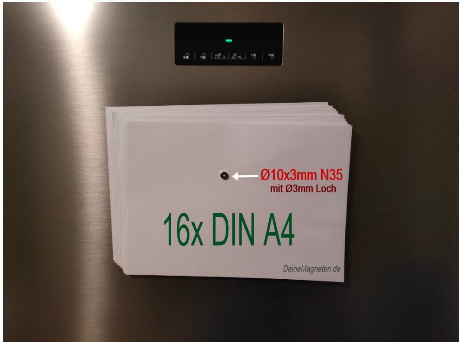
Tragfähigkeit unseres 10x3mm Neodym Scheibenmagneten mit 3mm Loch am Kühlschrank getestet.
