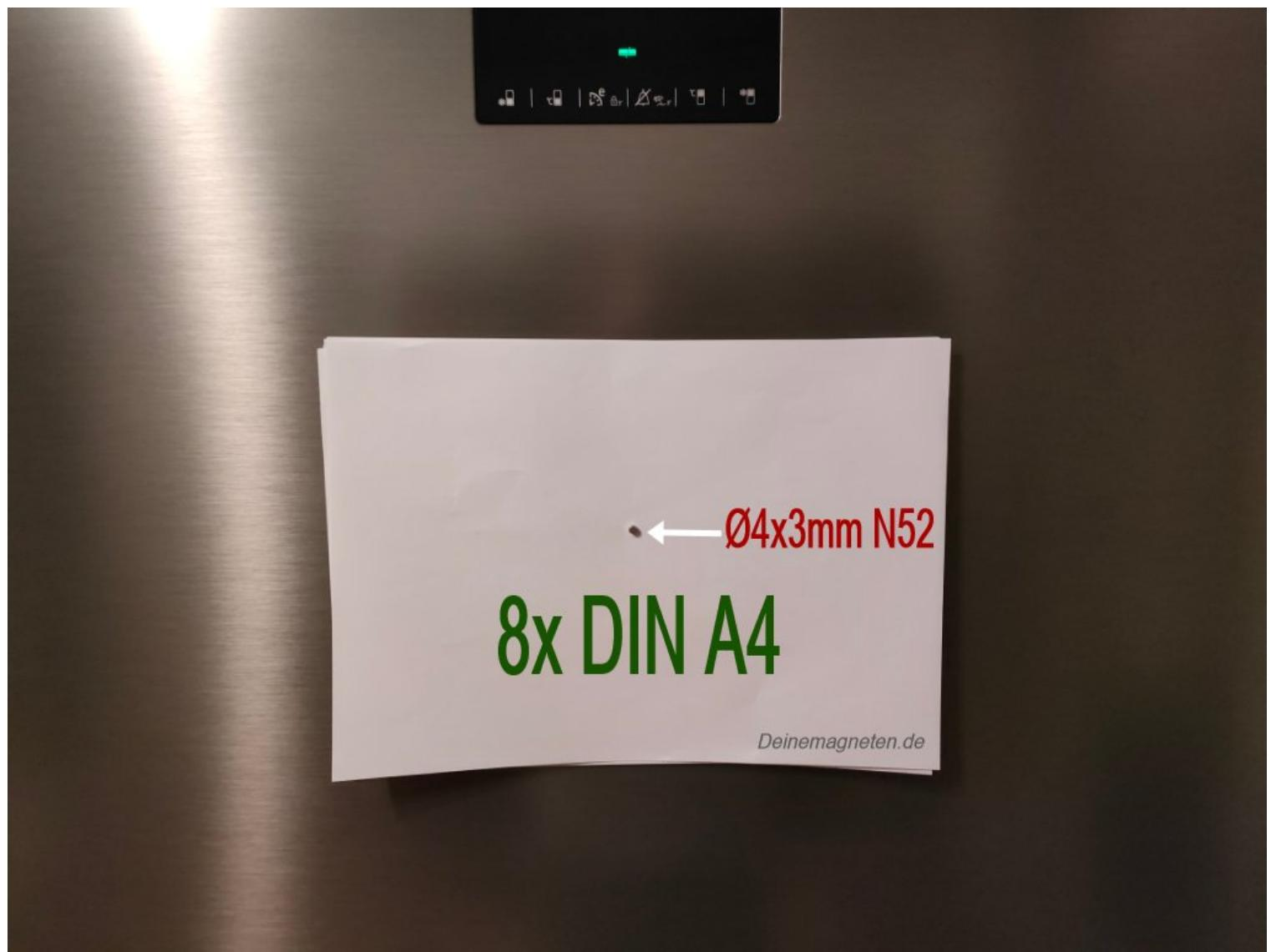
Den hier angebotenen 4x3mm N52 Neodym Magneten haben wir am Kühlschrank DIN A4 Papier halten lassen. Mit Mühe konnte er 9 Stück davon halten, allerdings rutschten diese nach ein paar Sekunden herunter. 8 Stück hielt er im Test jedoch problemlos auf dem Kühlschrank, sodass wir hier diese Mengenzahl als Testergebnis nennen können. Foto: deinemagneten.de
