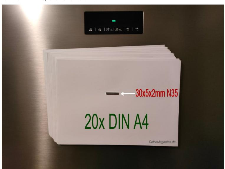
Getestet haben wir unseren verzinkten 30x5x2mm Neodym Blockmagneten auf einem Kühlschrank. Die Aufgabe des Magneten lautete: so viele wie möglich DIN A4 Blätter daran zu befestigen. Es sind insgesamt 20 Stück geworden. Foto: deinemagneten.de
