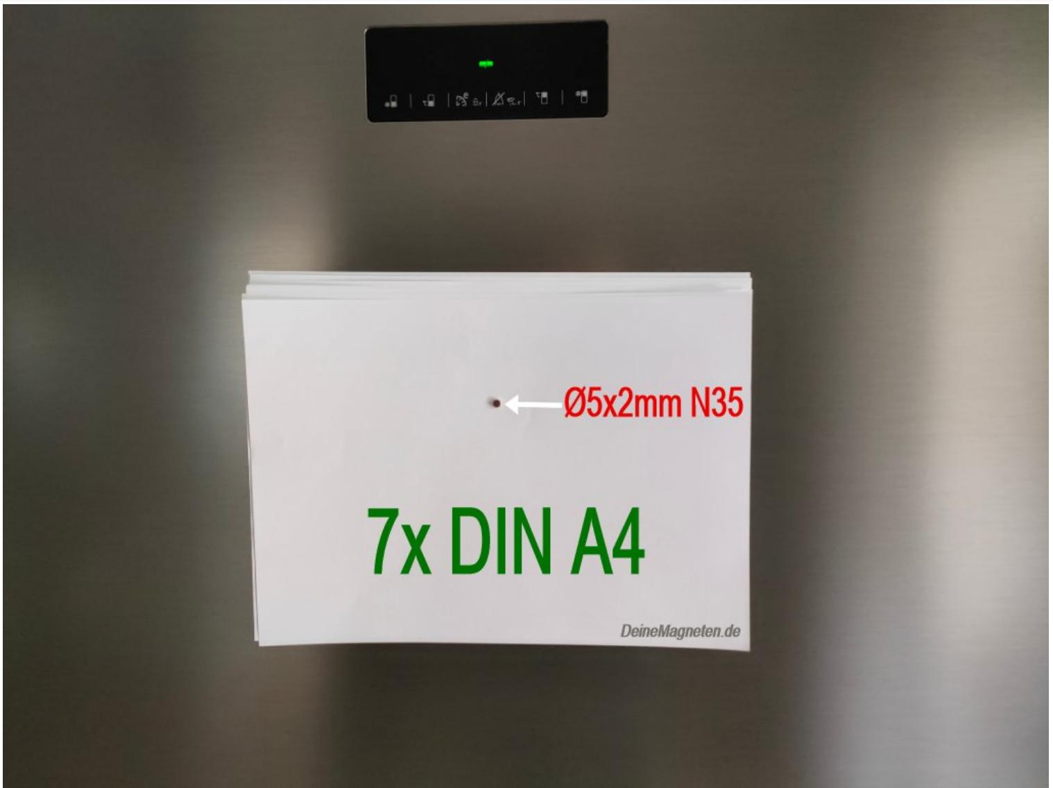
Runder NdFeB Starkmagnet 5x2mm N35 Grade am Kühlschrank. Foto: [deinemagneten.de](http://deinemagneten.de)
