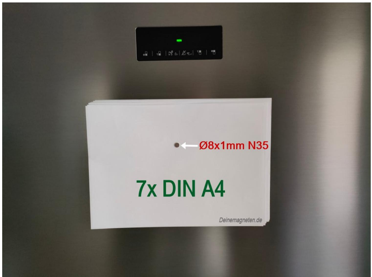
Wir haben ausprobiert, wie viele DIN A4 unser extrem flacher 8x1mm N35 Scheibenmagnet am Kühlschrank halten kann. Foto: [deinemagneten.de](http://deinemagneten.de)
